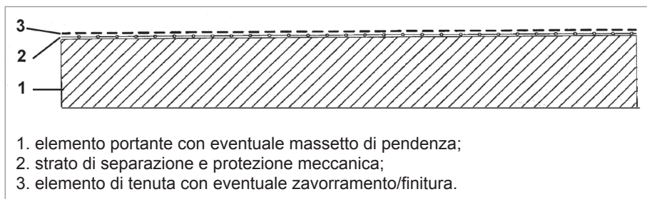
Figura 2.4 - Sezione di tetto freddo
