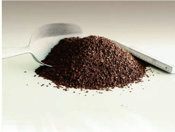
Figura 4.25 – Materiale da insufflaggio in scaglie di legno
