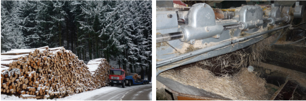
Figura 4.23 - (sinistra) approvvigionamento della materia prima; (destra) macchina sfibratrice al lavoro
